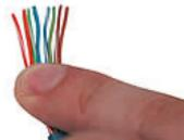
**6** – Die begradigten und sortierten Drähte sollten vorsichtig in den Steckverbinder eingeführt werden, wobei Sie die Kabelenden eindrücken, bis sie aus den Kontaktstiften heraustreten.
