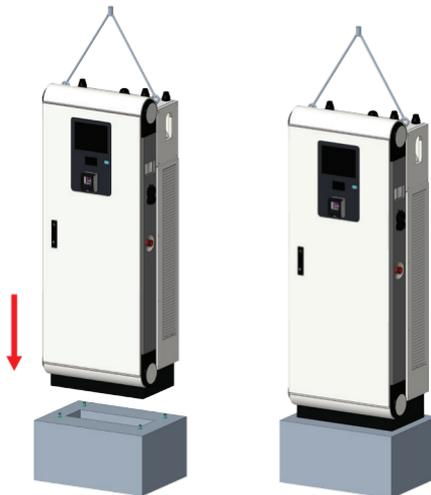
11. Nach dem Aufstellen der Ladestation entfernen Sie die Ringschrauben. Verwenden Sie Unterlegscheiben, um die Schrauben abzudecken.
